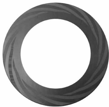
图 11 激光蚀刻加工技术加工的 GS-DGS 型槽端面
